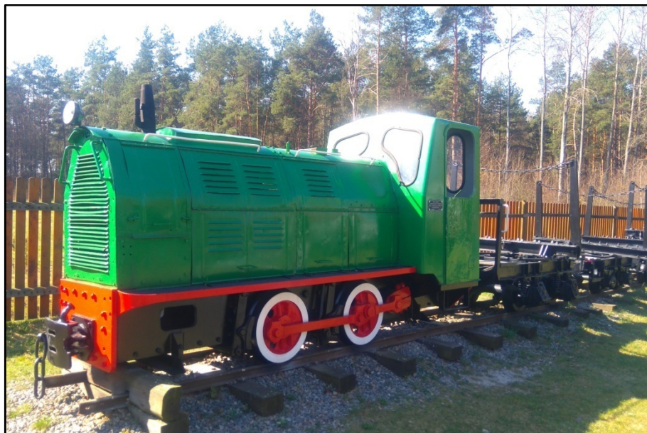
Wls50 na terenie Skansenu Kolei Leśnej w Janowie Lubelskim. Po wojnie wyprodukowano w Polsce ponad 2 tysiące lokomotyw Wls40 i Wls50 (różniły się zastosowanym silnikiem). Przez kilkadziesiąt lat były podstawowym modelem wąskotorowej lokomotywy przemysłowej w Polsce.
