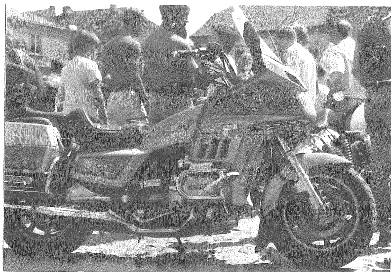
Honda Gold Wing, prod. japońskiej, poj. 1200 cm 3 , moc 100 KM, rocznik 1985, czterocylindrowy boxer, właściciel "Gucio" Gońka ze Skrzyszowa
